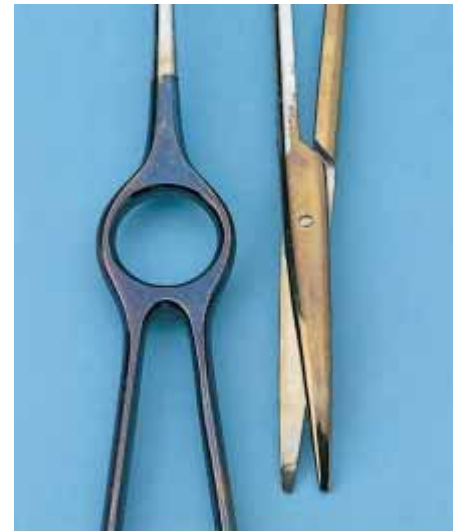
Verfärbung an Instrumenten. Ursache: Unzureichende Spülung
