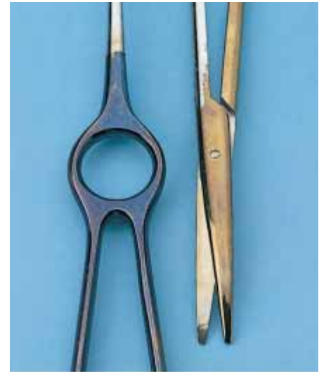
Instrumente mit Verfärbungen Discolored instruments
