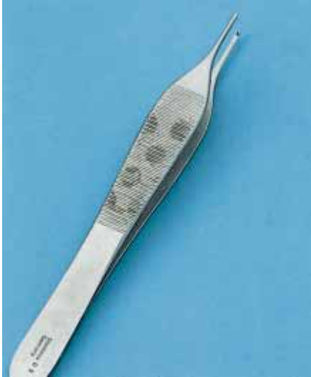
Flecken auf einer Pinzette Ursache: Unzureichende Dampfqualität
