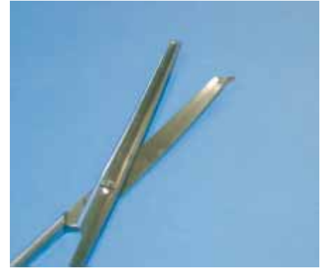
Schere mit abgebrochener Spitze. Ursache: unsachgemäßes Ablegen
