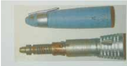
Blutrückstände an einem Handstück Ursache: unzureichende Reinigung
