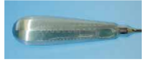
Flecken auf Instrumenten Ursache: Antrocknung von Wasser mit hohem Salzgehalt
