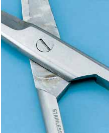
Korrosion an einer Schere. Ursache der Korrosion: Fehlende Pflege mit Öl Corrosion on scissors. Cause of corrosion: lack of maintenance, no oil
