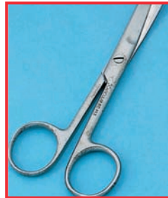
Schere mit Lochkorrosion
