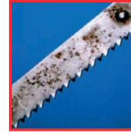
Rostbefall an einem verchromten Sägeblatt aus unlegiertem Stahl. Grund: Partieller Defekt der Chromschicht
