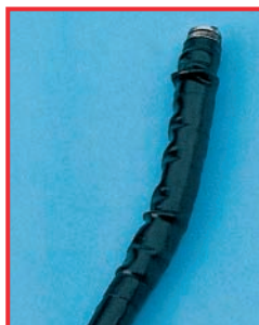
Aufquellen eines Einführungsschlauches durch Verwendung eines ungeeigneten Pflegemittels.
