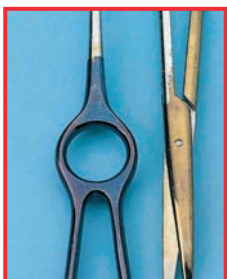
Verfärbte Instrumente durch Kieselsäure
