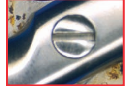
Detail Gelenkbereich Schere
