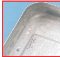
Materialangriff Grund: Behandlung mit alkalischem Reiniger
