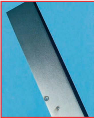
Korrosionsangriff auf Meißel
