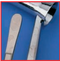
Verfleckungen auf Grund hohen Salzgehalts im Abspülwasser
