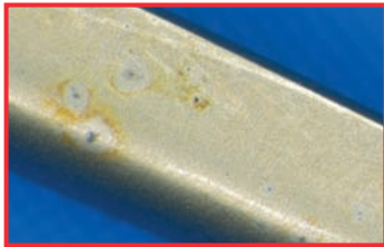
Chloridinduzierte Lochkorrosion auf dem Instrument
