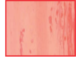
Materialangriff der Aluminiumoberfläche Grund: Behandlung mit stark alkalischem Reiniger
