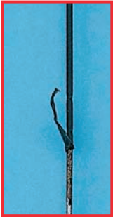
Beschädigte Isolierung an einem HF-Instrument
