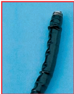
Aufquellung am Distalende eines Fiberskops
