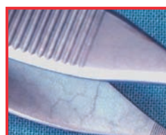
Instrumentenverfärbung mit Fleckenrändern
