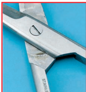
Reibkorrosion infolge fehlender Pflege mit Öl
