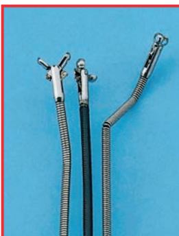
Gewaltsam beschädigte Biopsiezangen
