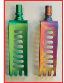
Linke Valve: fabriktreu – gleichmäßig grün Rechte Valve: maschinell gereinigt – bunt verfarbt
