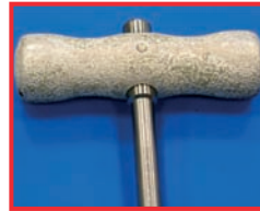
Materialangriff nur am Aluminium-Griffteil Grund: Behandlung mit stark alkalischem Reiniger
