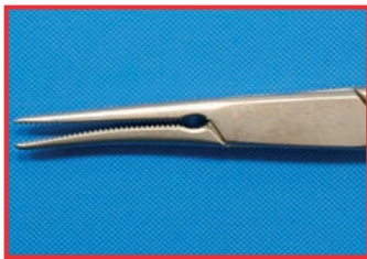
Verformung durch unsachgemäße Handhabung
