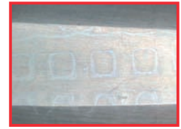
Instrumentenoberfläche mit Perforationsabbildung von Siebkorb
