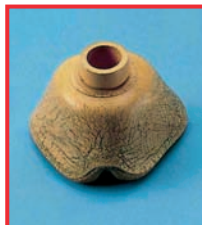
Alterungsrisse an einer Atemmaske
