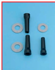
Aufgequollene Dichtungen als Folge von nicht gezielt aufgebrachtem Instrumentenöl.
