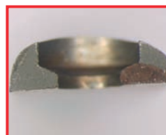
Bruchfläche in der Bohrungssenkung für Schraubenkopf
