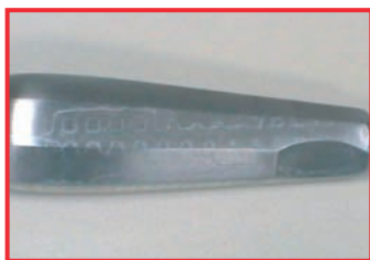
Verschleppung von Reinigungsmittelrückständen durch unzureichende Spülung
